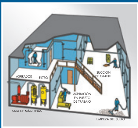
Aspiración centralizada de limpieza
